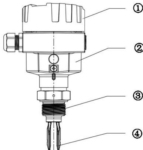
图 1 LSF02 整体结构图
