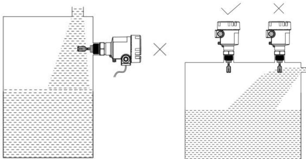
图 3 避开入料口的安装示意图
