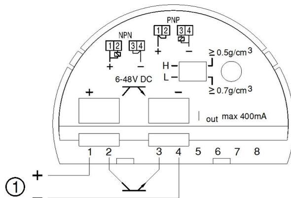
图8 晶体管(NPN/PNP)输出方式
